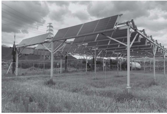
写真8 生育と発電に最適なパネル制御を検討するための実験の様子
